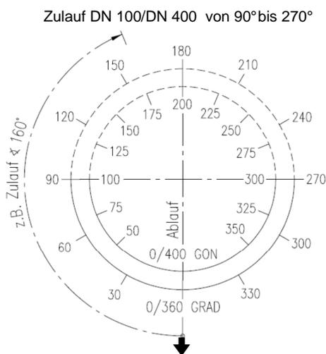
Auslauf DN 100/DN 400 bei 0°/360°
