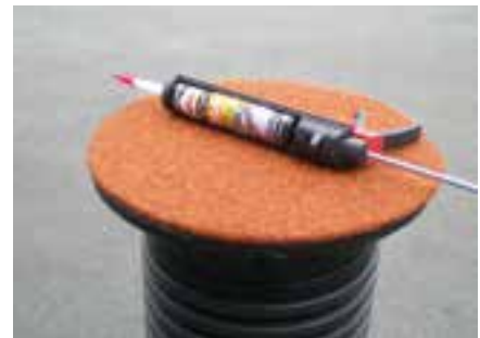
Beispiel: Filzbelag, Stärke ca. 1,5 cm, geeignetes Klebemittel
