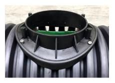
Das Sattelstück mit dem nach innen ausgerichteten Rohrstutzen in die Bohrung einsetzen und passgerecht auf der Außenfläche des Verbundrohres ausrichten. Für die Befestigung des Sattelstückes auf dem Rohr die beigefügten Befestigungsschrauben verwenden. Die Schrauben jeweils mittig auf dem Wellenberg einschrauben.
